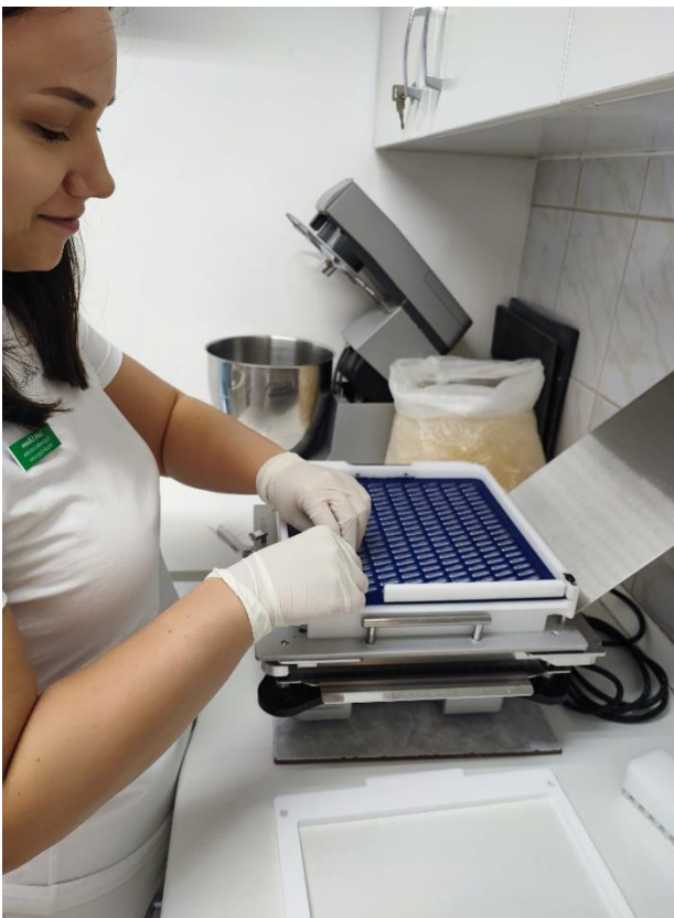
Kézi kapszulázógép vibrációs asztallal és „00” méretű elkészített kemény zselatin kapszulák
